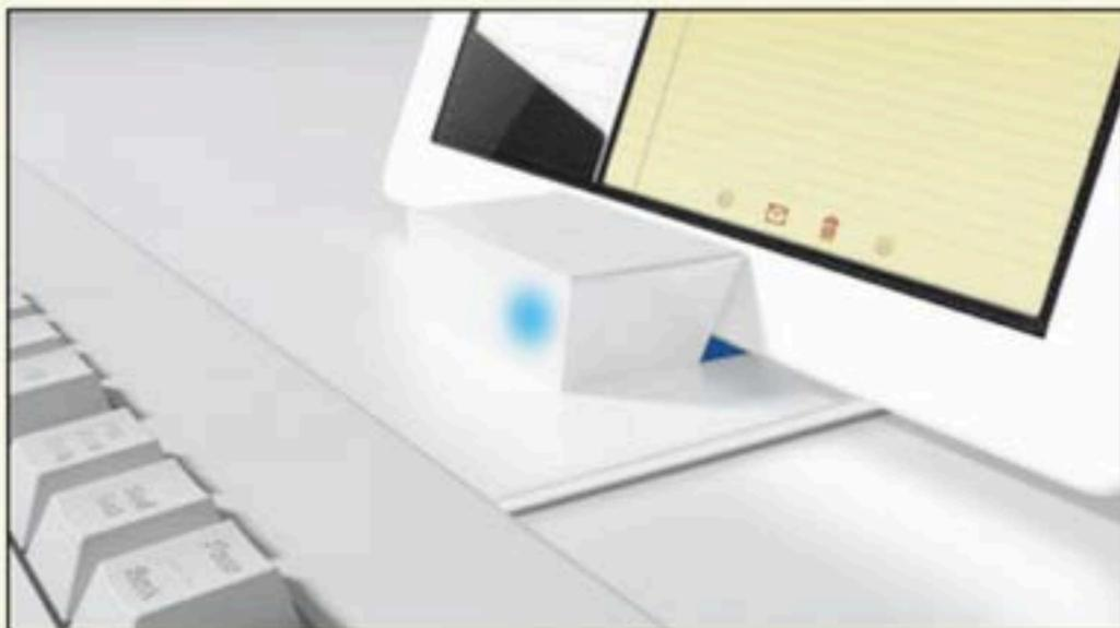
普段PCに接続して使っているお気に入りのキーボードをタブレットでも使いたいというとき、途中に噛ませるだけでBluetooth接続に変換してくれるデバイスが「EneBRICK」です。本体にはモバイルバッテリーも内蔵しているので、スマートフォンやタブレットの外部バッテリーとしても使うことができます。
