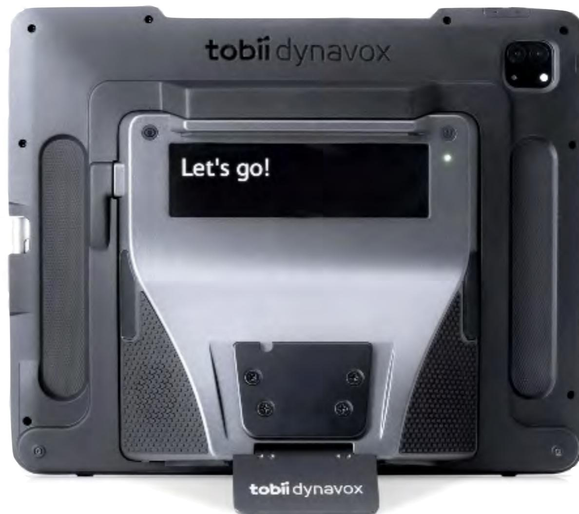
前面にはアイトラッキング装置、背面にはステレオスピーカーに加えて、テキストを表示するための小さなスクリーンが備わる。このデバイスのユーザーは、Tobii独自のテキスト音声変換アプリ「TD Talk (TDトーク)」または他の任意のアプリを使って、テキストまたは音声でコミュニケーションをとることができる
