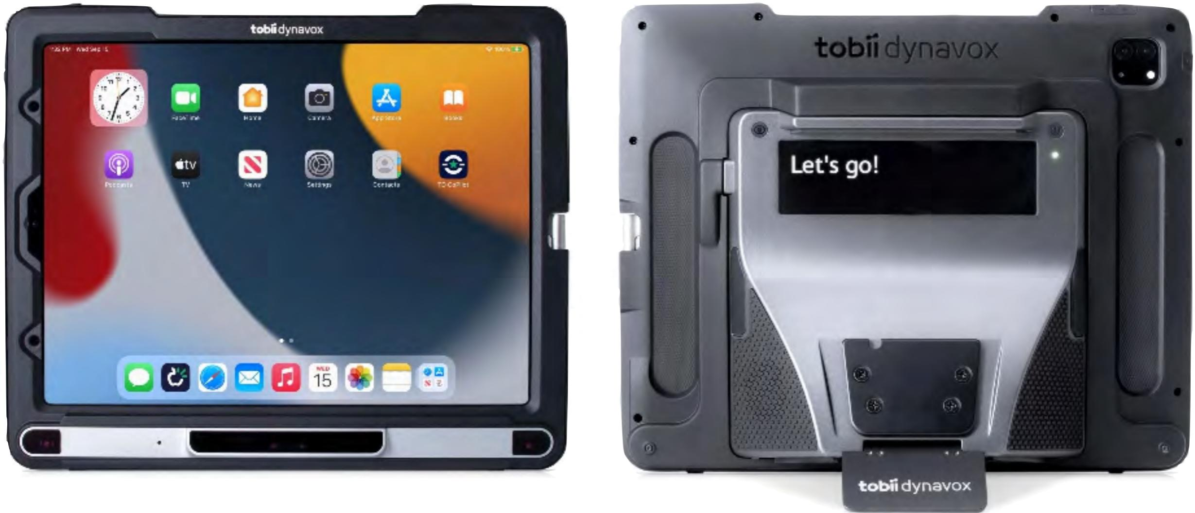
前面にはアイトラッキング装置、背面にはステレオスピーカーに加えて、テキストを表示するための小さなスクリーンが備わる。このデバイスのユーザーは、Tobii独自のテキスト音声変換アプリ「TD Talk (TDトーク)」または他の任意のアプリを使って、テキストまたは音声でコミュニケーションをとることができる
